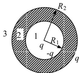
8-7 半径为 $R_0$ 的金属球，带电 $+Q$ ，置于一内外半径分别为 $R_1$ 和 $R_2$ 的均匀介质球壳中，介质的相对介电常数为 $\epsilon_r$ ，如图 8-7 所示。求：(1) 电场强度和电位移分布；(2) 电势分布；\* (3) 介质中的电极化强度；\* (4) 介质壳内外表面上的极化电荷面密度。
