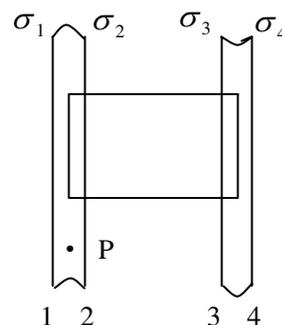
解：(1) 取两底面分别位于两导体板内部的柱面为高斯面，设底面面积为  $\Delta s$ ，则由高斯定理得
