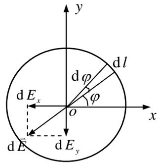
解: 在圆环上任取一段  $d\mathbf{l}$ ,  $d\mathbf{l}$  到  $o$  点的连线与  $x$  轴夹角为  $\varphi$ , 则  $d\mathbf{l}$  段上的电荷
