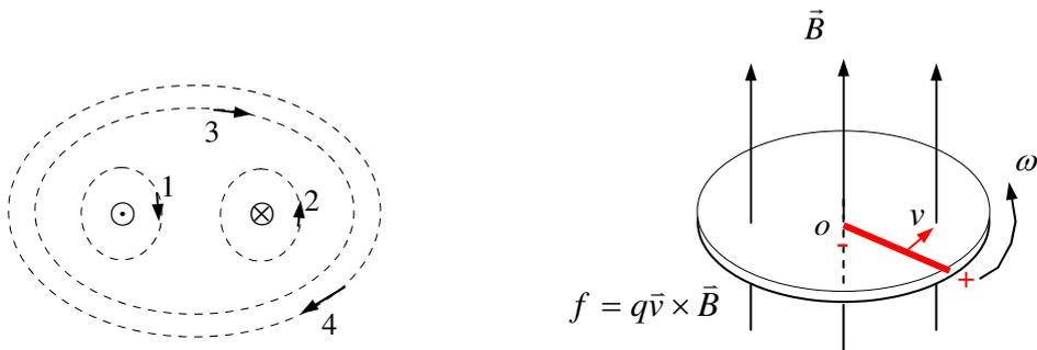
4. 圆铜盘水平放置在均匀磁场中， $\vec{B}$  的方向垂直盘面向上，当铜盘绕通过中心垂直于盘面的轴沿图示方向转动时
