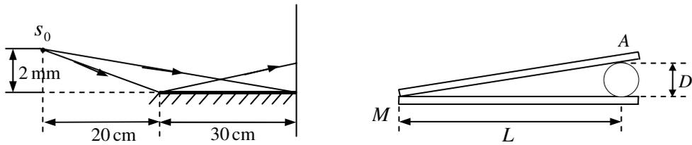
4. 如图，在长度为4cm的两块玻璃平板之间夹一细金属丝，形成空气劈尖，在波长为 $\lambda = 600.0 \text{ nm}$ 的单色光垂直照射下形成干涉条纹。如果观察到相邻两明条纹间隔为 $\Delta l = 0.1 \text{ mm}$ ，则金属丝直径为 $D = \underline{\hspace{2cm}}$  mm。如将金属丝通电，使之受热膨胀，则在上方A处可观察到干涉条纹向 $\underline{\hspace{2cm}}$ 方向移动，条纹间距变 $\underline{\hspace{2cm}}$ （密或稀）。若在A处观察到干涉条纹移动6条，则金属丝直径的热膨胀量为 $\underline{\hspace{2cm}}$  mm。
