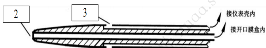
(1) 动压孔 (2) 总压孔 (3) 静压孔
